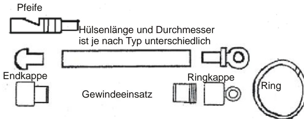
>Schneiden Sie den Holzrohling entsprechend der Hüslenlänge (+ ca 2 mm), bohren Sie den Rohling. Kleben Sie die Hülse ein (wir empfehlen Starbond Glue EM 150, Hüslen ev. außen leicht anschleifen)
