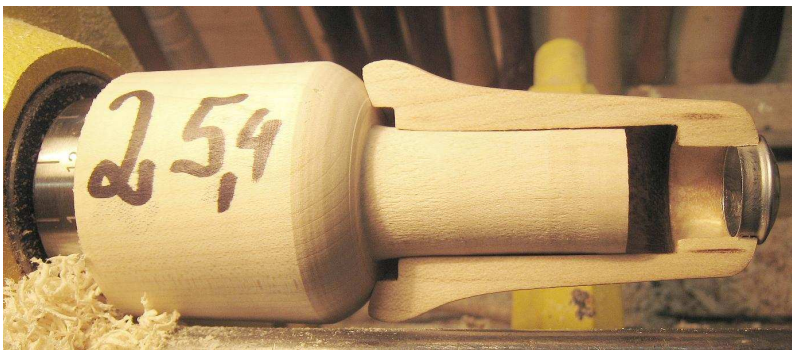
Hilfsfutter (Zapfenmaß 25,4 mm) mit direkt eingeschnittenem Spindelgewinde
