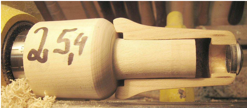
Hilfsfutter (Zapfenmaß 25,4 mm) mit direkt eingeschnittenem Spindelgewinde
