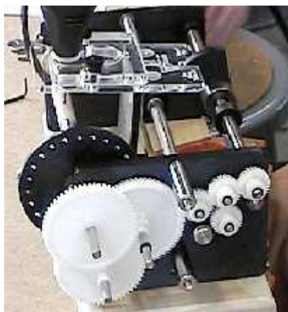
Durch Wechseln und Umstellen der Zahnkränze werden Spiralen, Linien oder Windungen erstellt
