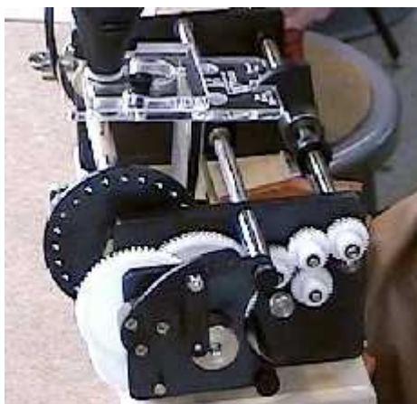
Pen Wizard mit angebauter Guillochier-Vorrichtung (zur Erstellung von Zackenlinien)
